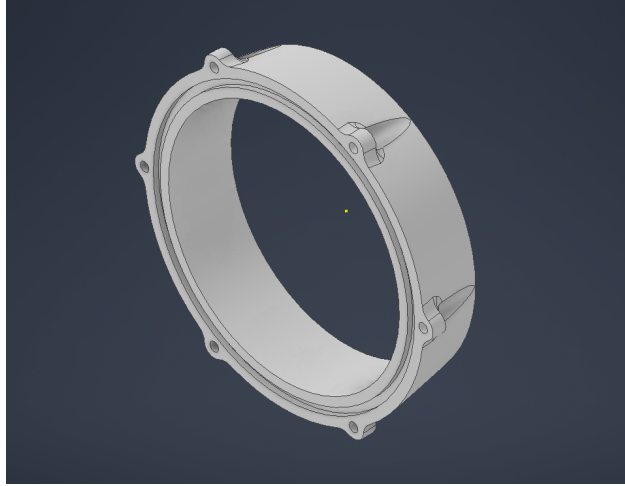
Figure 4.10 Vue de l'anneau de jointure sur Inventor
