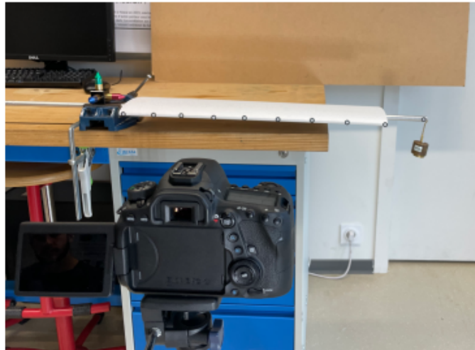
FIGURE 2.19 – Montage pour l'expérience de flexion du tube
